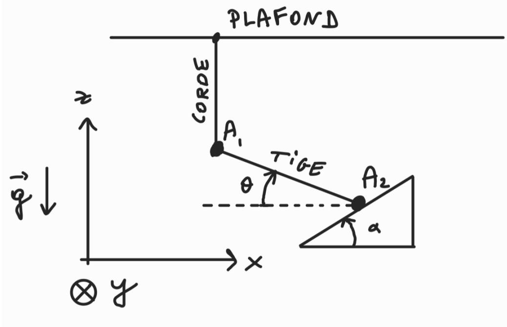
Figure 2: Deux masses sont reliées par une tige suspendue au plafond et posée sur un plan incliné.
