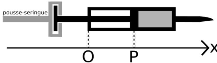
Figure 3: Le point  $O$  est pris pour origine, l'axe des  $x$  est vers la droite, et le point  $P$  représente le bout du piston.
