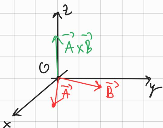
$\vec{A}$  et  $\vec{B}$  sont dans le plan  $Oxy$  et donc  $\vec{A} \times \vec{B}$  est parallèle à  $Oz$ .
