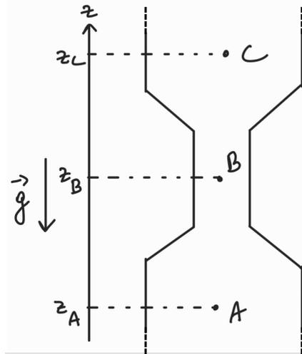
Figure 4: Un fluide s'écoule vers le bas dans une conduite de diamètre variable. On ne montre ici qu'une portion de la conduite, le système n'est pas ouvert à l'atmosphère.
