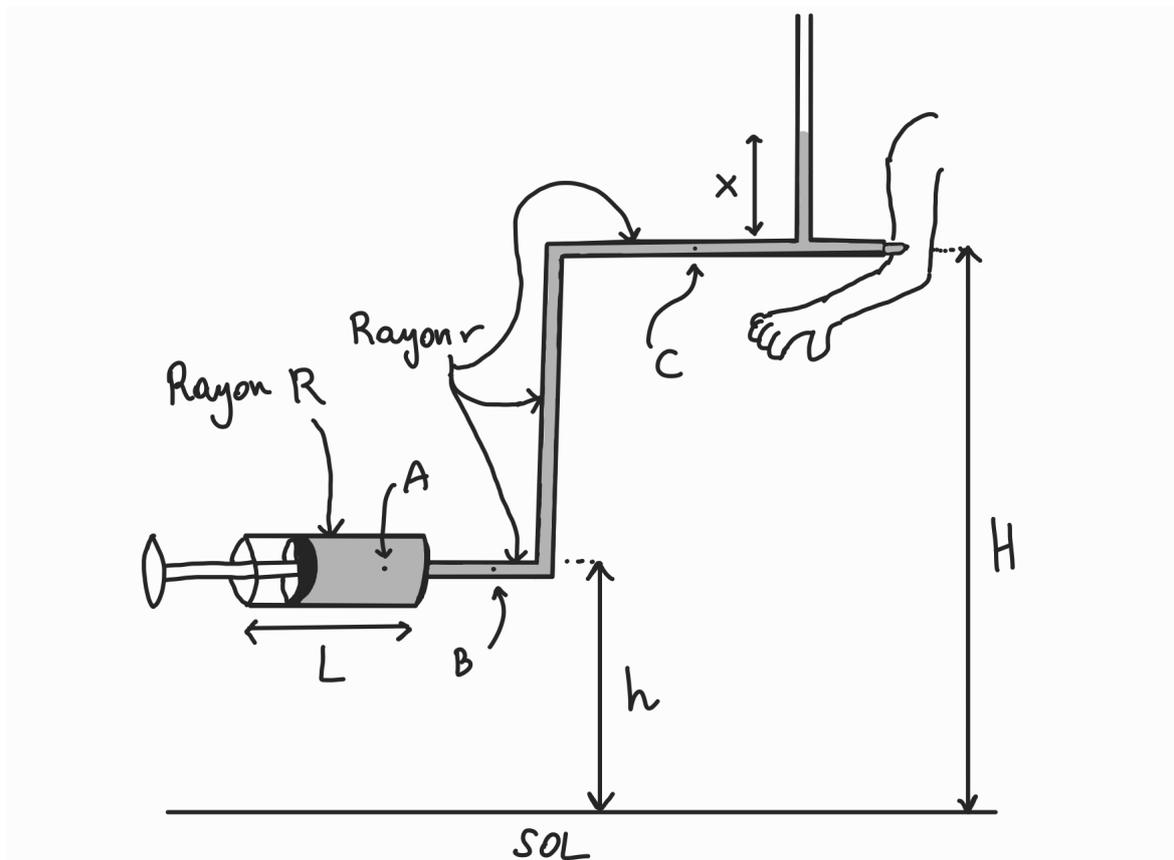
Figure 7: Une seringue pousse du liquide dans le bras d'un patient. Le point  $A$  est dans la seringue. Le point  $B$  est à la même hauteur que la seringue mais est dans le tuyau flexible. Le point  $C$  est également dans le tuyau flexible mais à la même hauteur que l'aiguille. On note  $p_A$  la pression du fluide en  $A$  et idem pour  $p_B$  et  $p_C$ .
