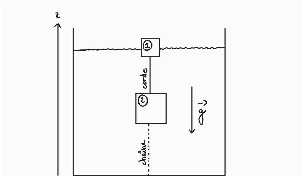
Figure 1: Deux blocs sont attachés ensemble par une corde tendue dans une bassine. Le bloc du dessous est attaché par une chaîne au fond de la bassine. Nous prenons l'axe des  $z$  comme indiqué sur la figure.
