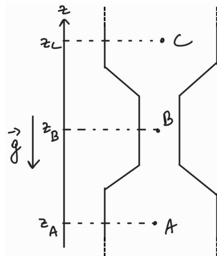
Figure 6: Un fluide s'écoule vers le bas dans une conduite de diamètre variable. On ne montre ici qu'une portion de la conduite, le système n'est pas ouvert à l'atmosphère.
